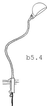
weiß lackierte Aluguß-Klemme, verchromter Stahl-Flexarm, Zuleitungskabel 270cm mit weißem Schnurzwischenschalter, verchromte Metallfassung mit Außengewinde; Maße: Flexarm Länge 60cm, Klemmweite ca. 0-7cm
